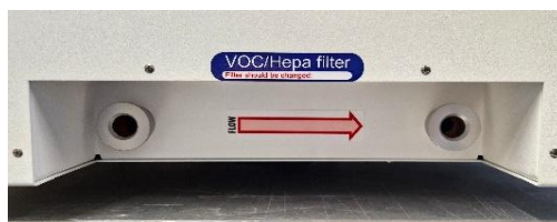
Фигура 12.1 Стрелка за посоката на потока на многокамерния IVF инкубатор Mini MIRI® Dry
