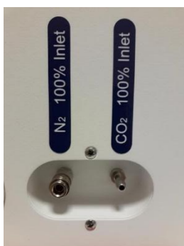
Фигура 11.1 Входни отвори за газ на задната страна на Mini MIRI® Dry и Mini MIRI® Humidity многокамерни IVF инкубатори
