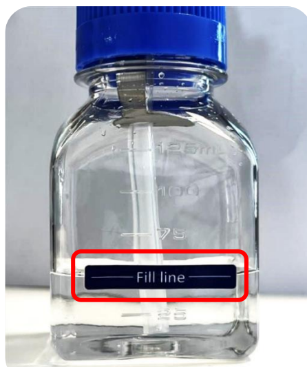
Фигура 22.2 Индикатор за ниво на запълване в бутилката за овлажняване
